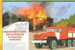
Пожарные автомобили и мотопомпы, приспособленная и переоборудованная техника для тушения пожаров должны быть укомплектованы пожарно-техническими веществами и находиться в исправном состоянии. Порядок привлечения техники для тушения пожаров определяется расписанием выезда и планом привлечения сил и средств для тушения пожаров, утвержденным органом местного самоуправления.
